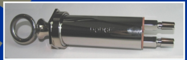
Cód. 5977 Bomba Metálica para Inyección y Aspiración Fabricado en Zinc Cromado Conexiones para Tubo de Inyección y Aspiración 7 mm. Pistón con Junta Torica. Largo 185 mm. Diam. 38 mm. Capacidad 28 cl.
