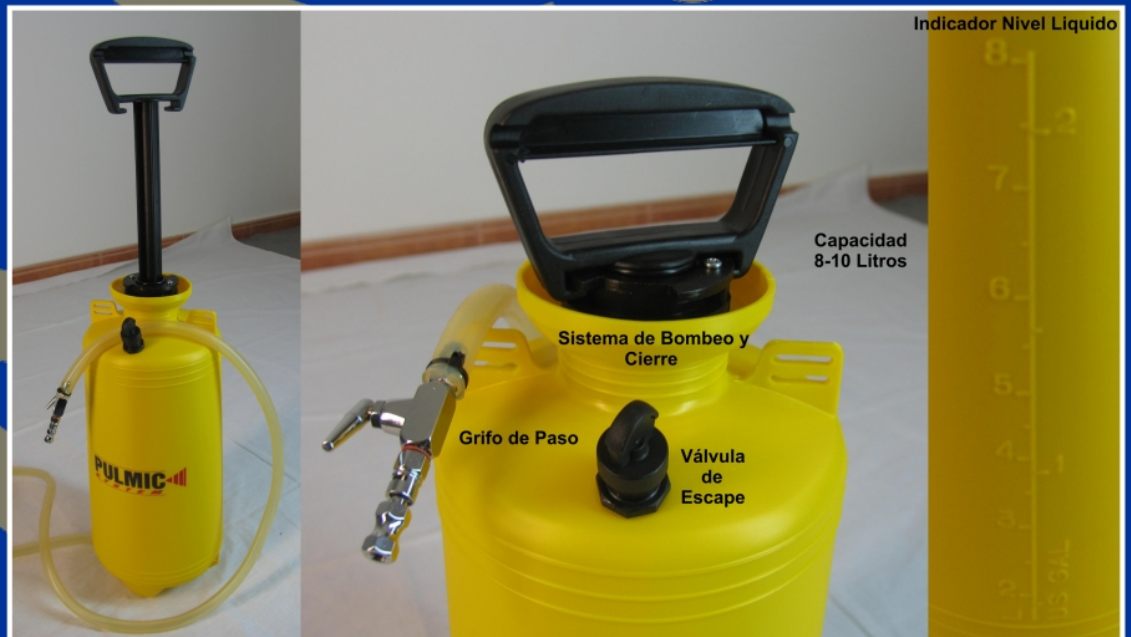
Cód. 4961 Bomba ECO-PAST Completa CHAO para Inyección de líquidos Capacidad de 8 a 10 Litros
